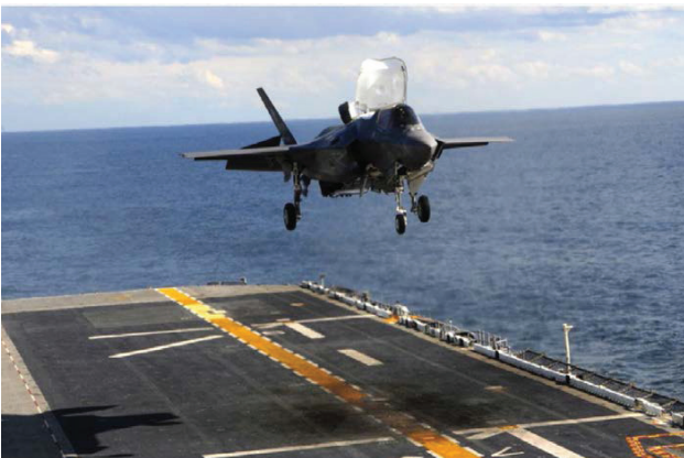
รูปที่ ๑๑ เครื่องบินโจมตีขับไล่ขึ้นลงทางดิ่งแบบ F-35
