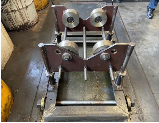
รางเลื่อน Sleeve เหล็กใบจักรเรือหลวงกระบี่
